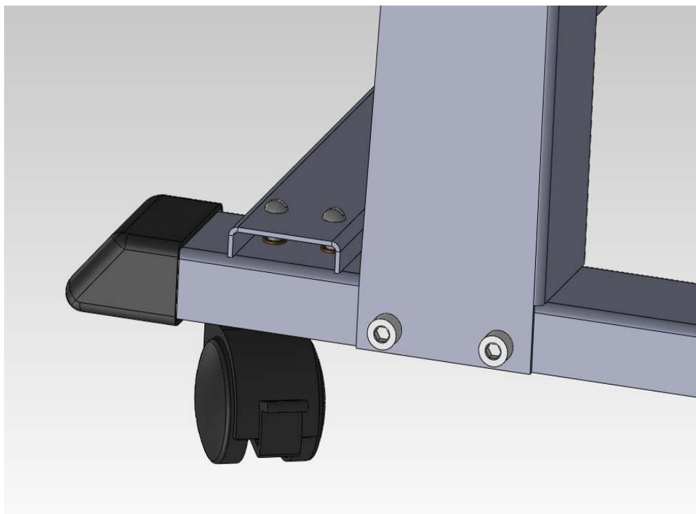
Установка стойки к основанию с установленными роликами прикручиваются винтом с внутренним шестигранником (в комплекте прилагается винт М8 и шестигранный ключ).
