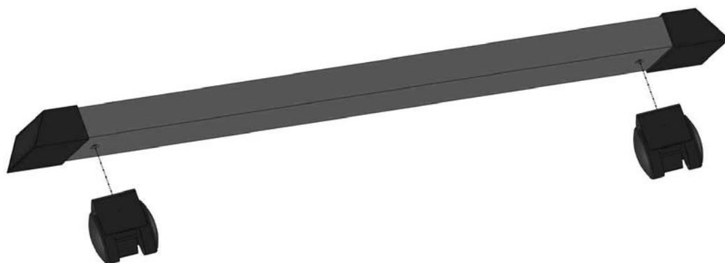
Основание с установленными роликами прикручивается винтом М6 на распорную перекладину.
